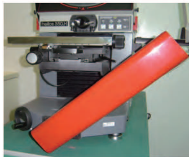
多功能旋轉式燈座，可用表面燈測量較長的待測物，而無空間限制。
